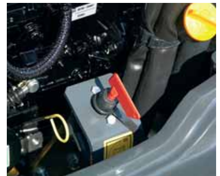
Der Hauptschalter für die Batterie gehört zur Standardausrüstung und befindet sich abschließbar unter der Motorabdeckung.
