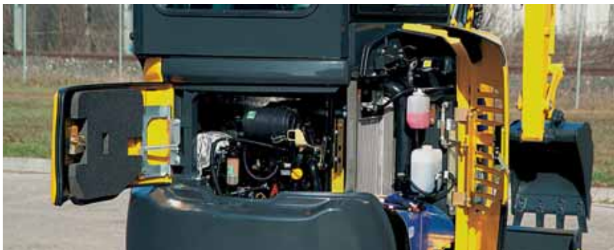
Hintere Wartungsklappen für schnelle Motorinspektion und Betankung, einfachen Wartungszugang, leichte Reinigung der Kühler und guten Zugang zur Batterie
