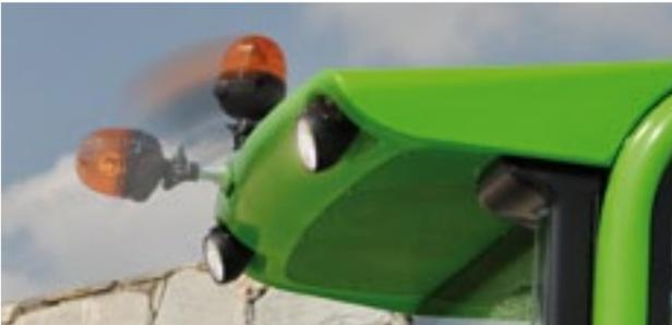
◀ Das **abklappbare Rundumlicht** reduziert bei Bedarf die Kabinenhöhe. Aus demselben Grund ist der Kondensator der optionalen Klimaanlage bündig im Kabinendach untergebracht.
