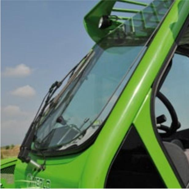
◀ Für eine bessere natürliche Lüftung lassen sich die **Front- und Heckscheibe** öffnen. Das Heckfenster dient zudem als Notausstieg.
