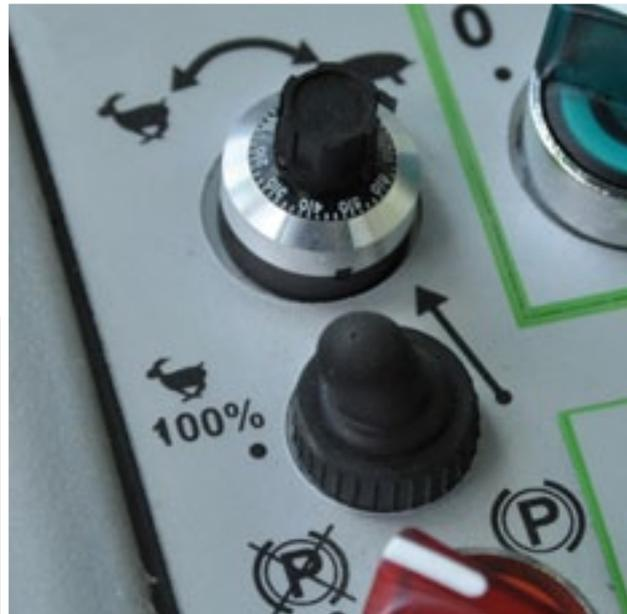
Die serienmäßige **Funktion des Inchens (der Kupplung)** wird wahlweise **per Pedal oder über ein Potentiometer** an der Bedienkonsole betätigt. Sie erlaubt die präzise Anpassung der Fahrgeschwindigkeit bei konstanter Motordrehzahl, z.B. um eine schnelle Hubgeschwindigkeit bei Verladearbeiten sicherzustellen. Die **Fahrstufenumschaltung** und die **Feststellbremse** werden elektrisch betätigt. Bei abgeschaltetem Antriebsmotor wird die Feststellbremse zudem automatisch aktiviert.
