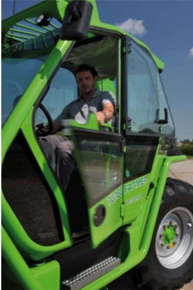
Dank praktischen Stufen und flachem Boden ist der **Einstieg in die Kabine** bequem und sicher. Die **oberen und unteren Türsegmente** lassen sich ganz nach hinten klappen.
